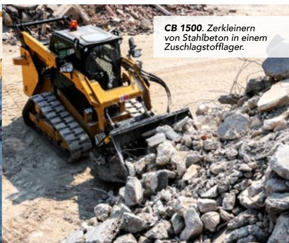
**CB 1500.** Zerkleinern von Stahlbeton in einem Zuschlagstofflager.
