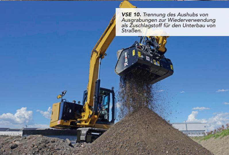
**VSE 10.** Trennung des Aushubs von Ausgrabungen zur Wiederverwendung als Zuschlagstoff für den Unterbau von Straßen.
